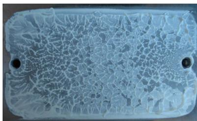
图 2-3. 拆卸后电源模块上的油脂
