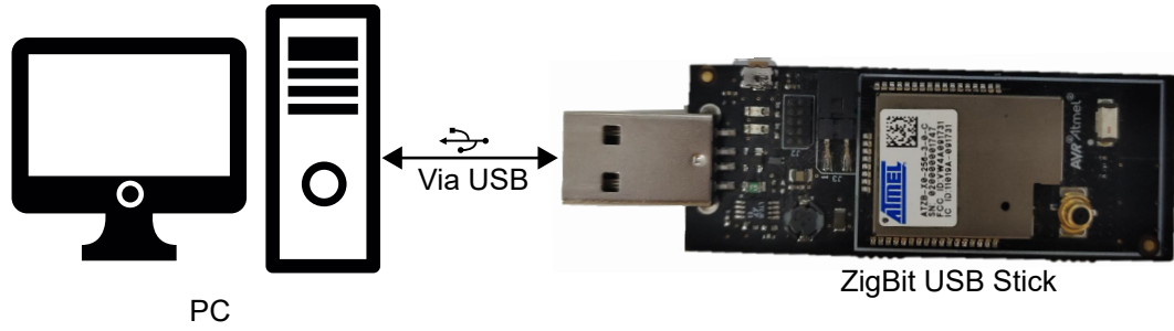
图 2-16. 将 ZigBee USB 设备连接到 PC
