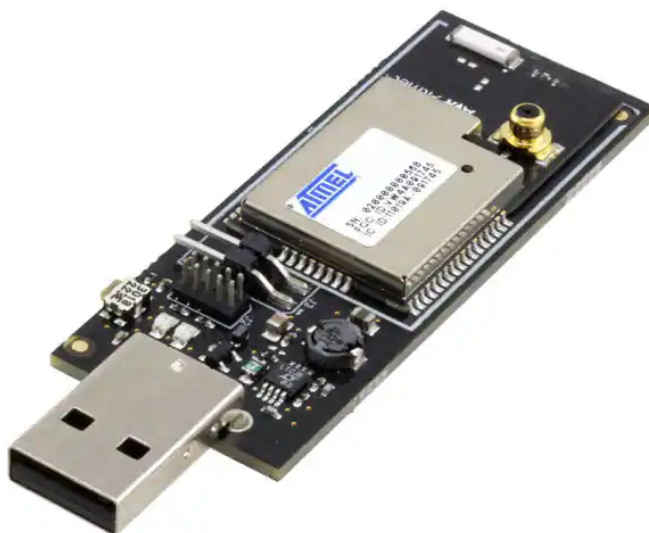
图 2-1. 支持的嗅探器硬件平台——ZigBit USB 设备（RF212B/RF233——Sub-GHz/2.4 GHz）
