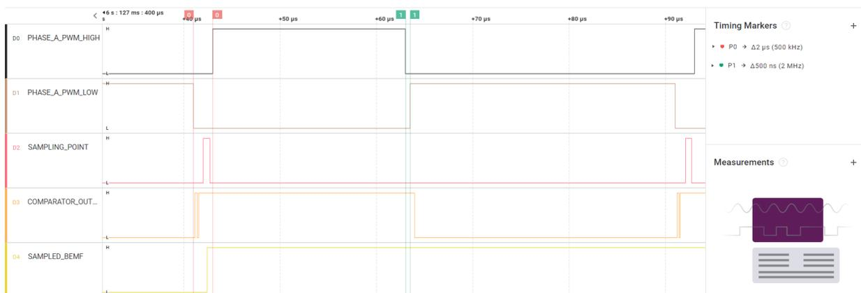
图 6-3. 电机三相及其采样得到的 BEMF 信号
