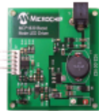
MCP1630DM-LED2也演示了升压拓扑结构在LED应用中的使用，采用MCP1630和PIC12F683器件。
