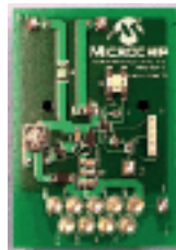
MCP1650DM-LED2演示了升压拓扑结构在LED应用中的使用，采用MCP1650和PIC10F202器件。
