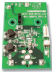
MCP1650DM-LED1演示了SEPIC拓扑结构在LED应用中的使用，采用MCP1651和PIC10F206器件。
