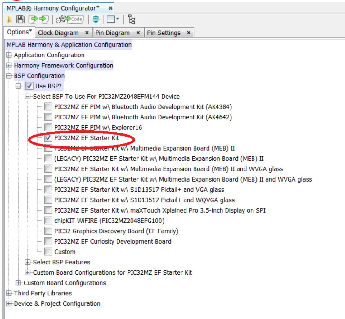
(四) 根据单板的实际情况修改 BSP 配置，作为演示，本文中仅将 LED 输出的 3 个引脚名称更改一下。
