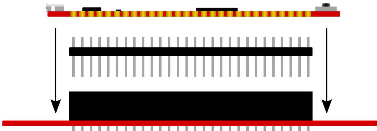
图 4-3. 连接到适用于 Click board™ 的 Curiosity Nano 基板
