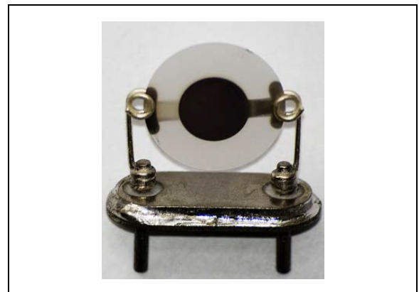
图 2: 石英晶振的传统构造
