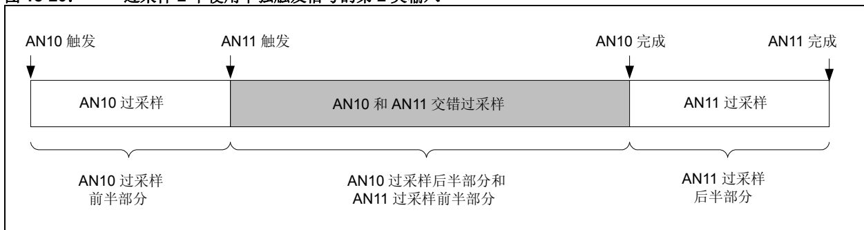
图 18-20: 过采样 2 个使用单独触发信号的第 2 类输入
