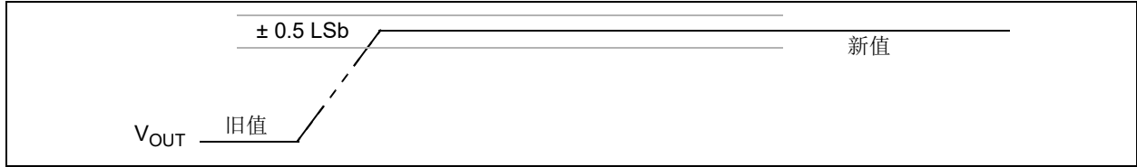
图1-1: V_{OUT} 稳定时间波形
