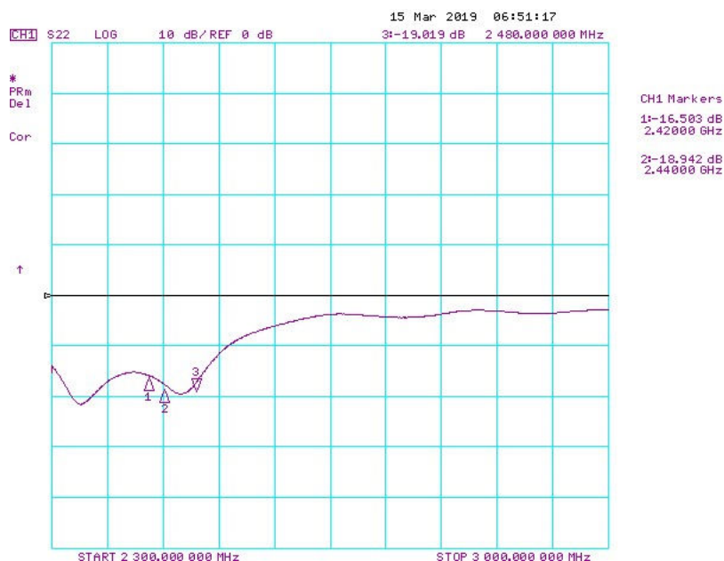
图 3-2. 2402 MHz 至 2480 MHz 频段范围内建议的天线回波损耗（右耳塞）
