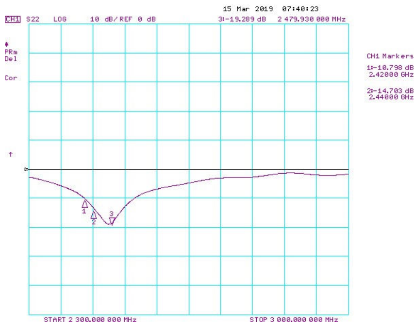
图 3-2. 2402 MHz 至 2480 MHz 频段范围内建议的天线回波损耗（右耳塞）
