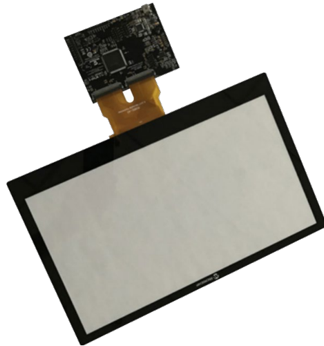
图 4. Microchip 的 ATEVK-MXT2952T2 评估工具包中包含一个带柔性连接器的专用传感器和一个电子控制板。
